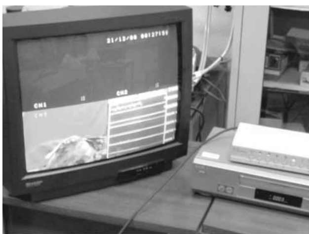
Figura 7. Monitor de televisión, grabador VHS y mezclador de video. Utilizado durante los experimentos. El monitor muestra la imagen de la articulación junto con las señales de los sensores de tensión-deformación.
